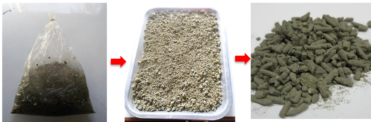
ภาพที่ 4 ขั้นตอนการผลิตชีวภัณฑ์เชื้อราแบบแห้ง
